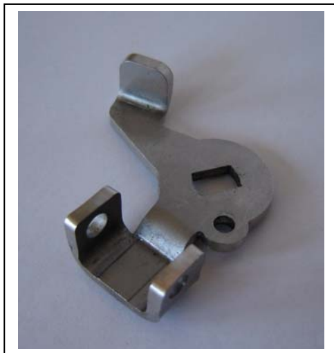
400-24; Hebel. Material X5 Cr Ni 18 10, Gewindeumformt, trovalisiert.
