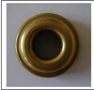
680-02; Dichtungsbüchse. Wasserpumpendichtung. Material: CuZn 30 tiefgezogenes Gehäuse, Grafit-Bakelit-Gleitring.
