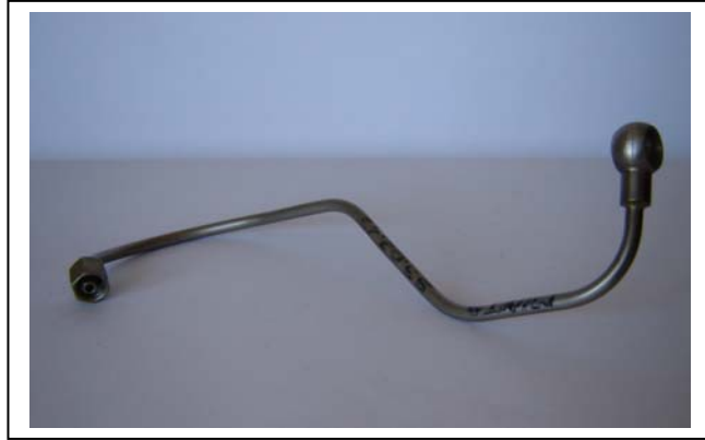
99-25; Benzinleitung. Nirostahlrohr mit Ringlötnippel, hartgelötet mit Schneidring Anschluss,
