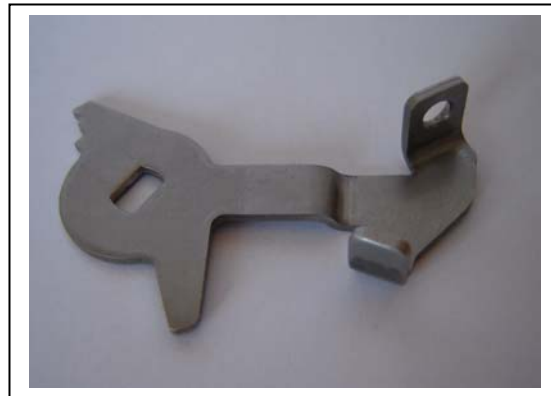
400-20, Hebel. X5 Cr Ni 18 10 mit kalibrierter Bohrung, trovalisiert
