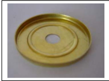
01-00-02-08, D28 mm Ventilteller für Thermostat, CuZn 30 Material, gestanzt, tiefgezogen, mehrere Verwendungsarten
