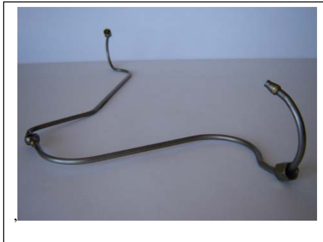
99-73; Benzinleitung Nirostahlrohr mit Ringlötnippel, hartgelötet mit Schneidring Anschluss
