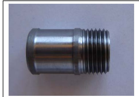
699-48; Gewindebuchse Material: Stahlrohr D18x2 mm, Gewinde gerollt
