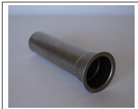
99-00-17-02; Zündkerzenrohr aus Nirostahl (liniengeschweisst) Durchmesser: d24,5x0,5 mm.
