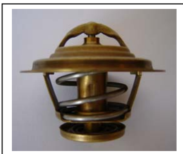
033-80; D30 mm Durchflussquerschnitt; Zweiweg-Thermostat, z.B. für PKW Typen: Alfa Romeo, Fiat, Lancia, Renault Öffnungstemperatur:: 80 C°; Hub 6 mm
