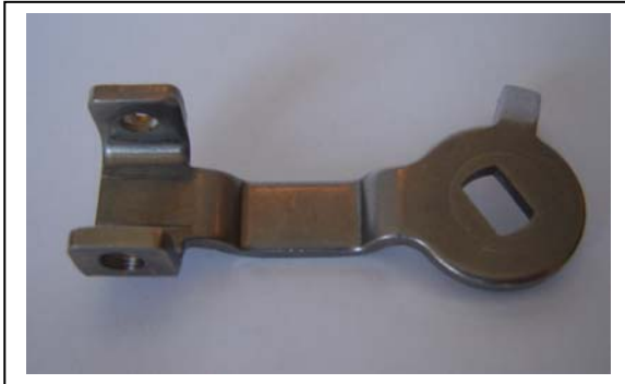
400-18; Hebel. Material X5 Cr Ni 18 10, Gewindeumformt, trovalisiert.
