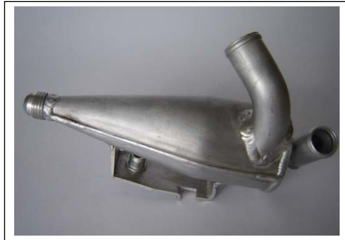
98-12; Ölabscheider Material: AlMgSi Rohr / Blech Einzelteile im Laserschneidverfahren hergestellt, in der Schweißvorrichtung zusammengestellt und mit WIG Verfahren händisch geschweißt.
