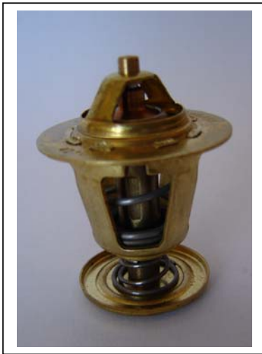
008-42; Zweiweg-Thermostat D19 mm Durchflussquerschnitt; Öffnungstemperatur: 42 C°; Hub 5 mm; Einbau: bei niedriger Arbeitstemperatur, für hohe Vibrationsbelastung
