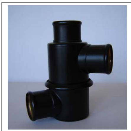
029-80; Für Lada - PKW, Zweiweg-Thermostat, Öffnungstemperatur: 80 C°; Hub 6 mm; CuZn 30 Gehäuse, gelötet, D30 mm Rohranschlüsse
