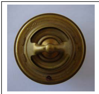
031-80; D30; Zweiweg-Thermostat Öffnungstemperatur: 80 C°; Hub 6 mm;
