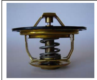
04-61-79; D50; Zweiweg-Thermostat Öffnungstemperatur: 80 C°; Hub 10 mm
