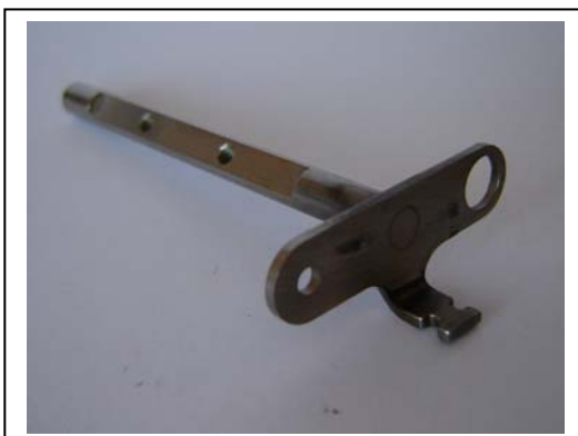
98-02-03; Drosselventilachse Nirostahl Blech gestanz, gebogen, hartgelötet.
