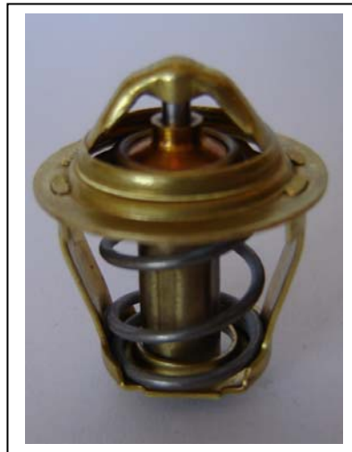
102-65; D19; Einweg-Thermostat Öffnungstemperatur: 65 C°; Hub 4 mm; Verwendung: Hobby Verkehrsmittel / Motor
