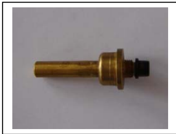
508-70; Temperaturfühler zur Luftventilsteuerung, Ikarus Bus pneumatische Ventilator-Kupplung, Arbeitsbereich 70-90 C °, Hub 0,05 mm/C °
