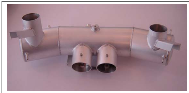
698-11 Luftverteiler Material: AlMgSi Rohr / Blech Einzelteile im Laserschneidverfahren hergestellt, in der Schweißvorrichtung zusammengestellt und mit WIG Verfahren händisch geschweißt.
