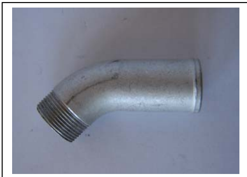
699-05; Kühlwasserkrümmer. Material: AlMgSi 0,7 Aluminium Rohr, D18x2 mm, Gewinde nach der Biegung gerollt
