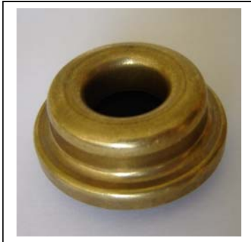
680-02; Dichtungsbüchse. Wasserpumpendichtung. Material: CuZn 30 tiefgezogenes Gehäuse, Grafit-Bakelit-Gleitring.
