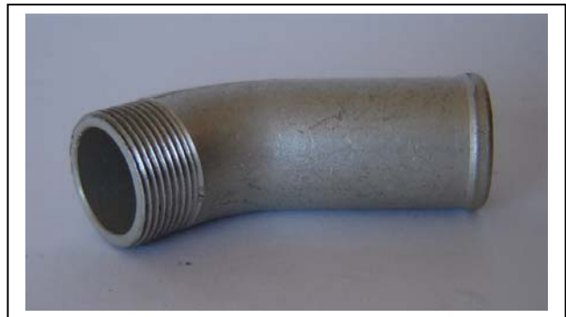
699-05; Kühlwasserkrümmer. Material: AlMgSi 0,7 Aluminium Rohr, D18x2 mm, Gewinde nach der Biegung gerollt
