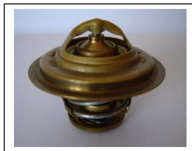
033-80; D30 mm Durchflussquerschnitt; Zweiweg-Thermostat, z.B. für PKW Typen: Alfa Romeo, Fiat, Lancia, Renault Öffnungstemperatur:: 80 C°; Hub 6 mm
