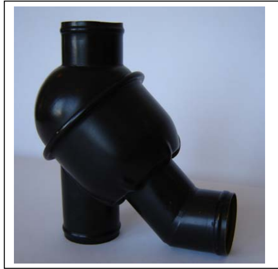
071-79; Steyer, Zweiweg-Thermostat für verschiedene Motortypen Öffnungstemperatur 80 C°; Hub 10 mm; hartgelötet, D45mm Rohranschlüsse Messinggehäuse
