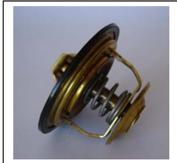
04-61-79; D50; Zweiweg-Thermostat Öffnungstemperatur: 80 C°; Hub 10 mm
