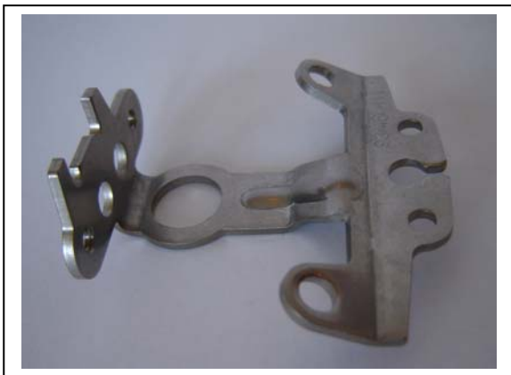
400-21; Gaszughalter X5 Cr Ni 18 10 Material, Gewindeumformt, trovalisiert. Zur Verstärkung mit Sicken
