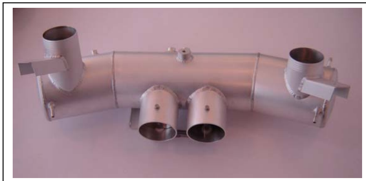
698-11 Előmelegített szívócső anyaga: AlMgSi cső, az áthatások 3D lézerrel készültek. Falvastagság 2mm, készülékben kézi AWI hegesztéssel gyártva, belül saválló pillangószeleppel
