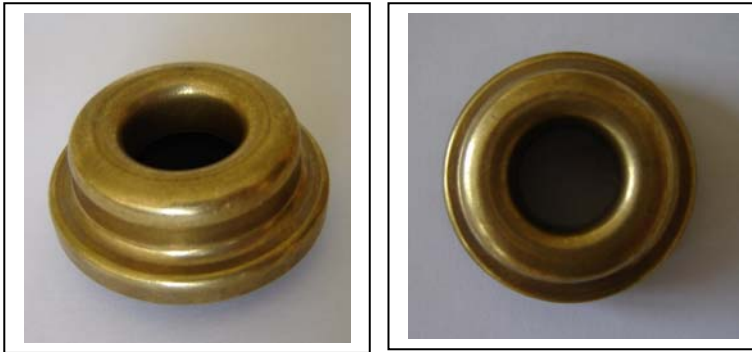
680-02; Vízszivattyú tömszelence anyag: CuZn 30 mélyhúzott ház, grafitos bakelit csúszógyűrűvel.
