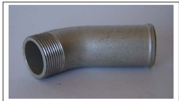
699-05; Hűtővízkönyökcső anyaga: 0,7 Alu cső, D18x2 mm, hajlítás után görgőzött menettel
