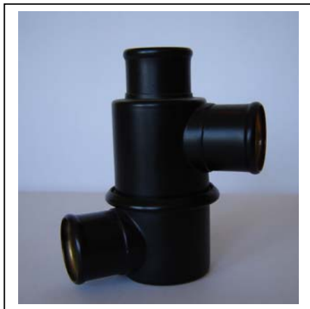
029-80; Lada, kétutas termosztát. Nyitóhőmérséklet: 80 C°; emelés: 6 mm; CuZn 30 ház, forrasztva , D30 mm-es csőcsatlakozás
