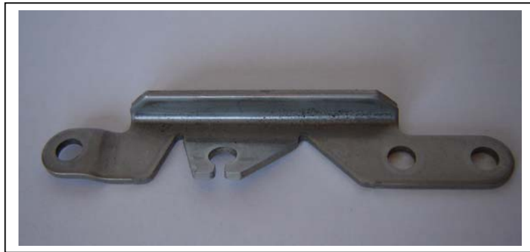
400-19; Bowdentartó anyag: X5 Cr Ni 1810, kalibrált furat, koptatott felülettel
