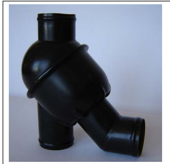
071-79; Steyer, Kétutas termosztát, különböző motortípusokhoz. Nyitóhőmérséklet: 80 C°; emelés:10 mm; keményforrasztva, D45mm-es cső. Sárgaréz ház.
