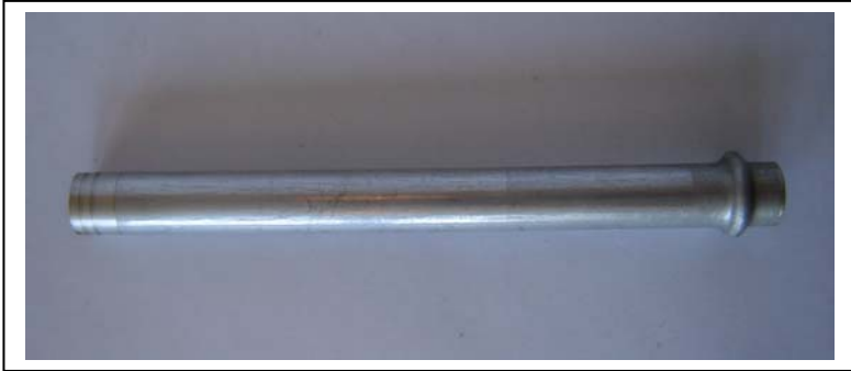
699-09; Szelepemelő védőcső D16 mm-es Alu csőből, gumibetéttel alakított kivitel.
