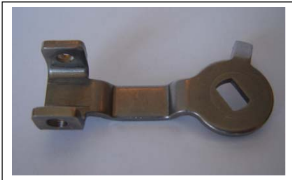
400-18; Emelő anyaga X5 Cr Ni 1810, formázott menet, koptatott felület
