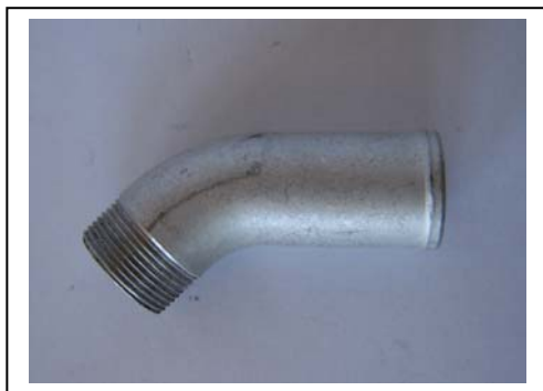
699-05; Hűtővízkönyökcső anyaga: 0,7 Alu cső, D18x2 mm, hajlítás után görgőzött menettel
