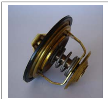
04-61-79; D50 mm kétutas termosztát, nyitóhőmérséklet: 80 C°; emelés 10 mm;
