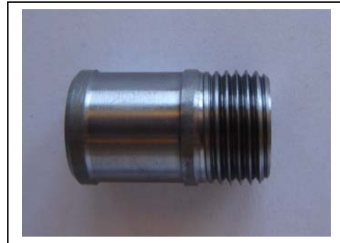
699-48; Menetes persely anyaga: D18x2 mm acélcső, görgőzött menet
