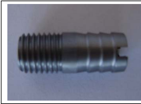
699-04; Bordázott cső, kúpos menettel egy felfogásban CNC esztergán forgácsolt
