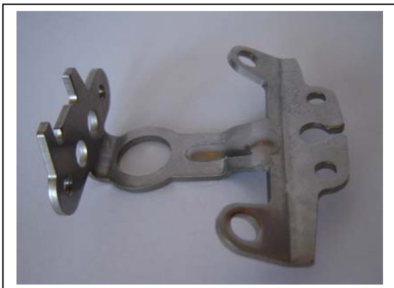
400-21; Gázbowden tartó anyaga X5 Cr Ni 1810 formázott menet, koptatott felület, bordanyomással merevítve.
