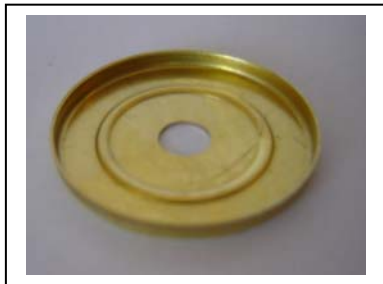
01-00-02-08; D28 mm termosztát alsó szeleptányér; anyaga CuZn 30, sajtolt, mélyhúzott, alkatrész, többcélú felhasználás
