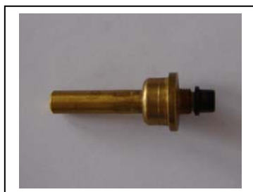
508-70; légszeleppatron, Ikarus busz, pneumatikus ventillátor, kuplung, nyitás 70-90 C °-ig, emelés 0,05 mm/C °
