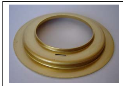
04-61-01-01; d50 mm termosztát gyűrű; anyaga: CuZn 30, sajtolt, mélyhúzott, többcélú felhasználás
