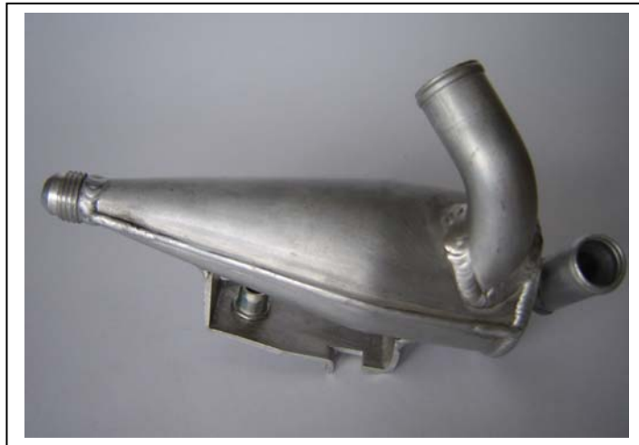
98-12; Olajleválasztó anyaga: AlMgSi cső, lemez, lézervágással, készülékben AWI kézi hegesztéssel összeállítva
