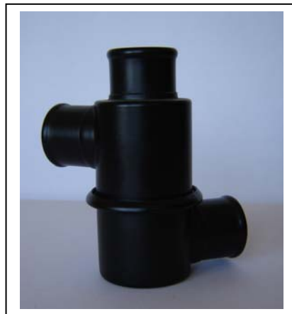
029-80; Lada, kétutas termosztát. Nyitóhőmérséklet: 80 C°; emelés: 6 mm; CuZn 30 ház, forrasztva , D30 mm-es csőcsatlakozás
